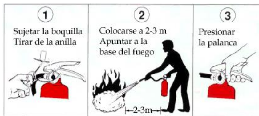
Figura 2. Correcto Uso del Extintor
